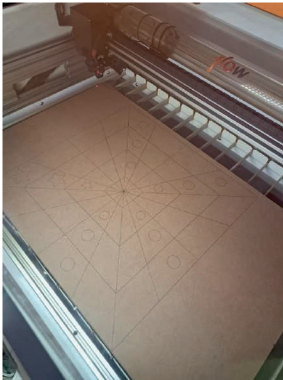
Imagem 2: protótipo do tabuleiro no processo de corte a laser
